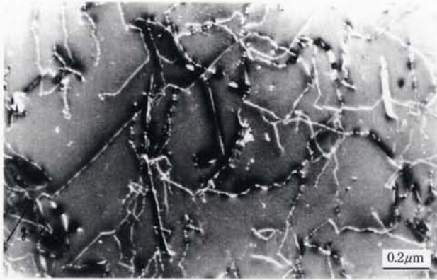
図9 アーク放電プラズマCVDによるダイヤモンド膜内部の転位を示すTEM写真。
