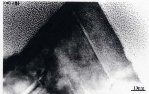
図10 マイクロ波プラズマCVD法によるダイヤモンドにみられる高密度双晶のTEM写真。
